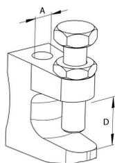
Morsetto per il fissaggio semplice direttamente sulle travature in acciaio. Il piatto di sicurezza STRAP M12 è richiesto per installazioni VdS oltre i Ø65 mm. Il piatto di sicurezza STRAP M12 è inoltre idoneo per vincolare il morsetto TKL in caso di carichi dinamici quali possono essere quelli innescati dal sisma.
