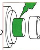
Blocca e sigilla permanentemente accoppiamenti cilindrici (cuscineti, ruote dentate, collari, pulegge, flange, etc). Evita montaggi forzati e chiavette. Consente lavorazioni meccaniche con tolleranze più ampie. Alta resistenza meccanica. Impedisce la corrosione. Non cola.
